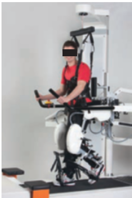
FIGURA 9. SISTEMAS DE ENTRENAMIENTO DE MARCHA CON SPP Y ASISTENCIA ROBOTIZADA, LOKOMAT® (WWW.HOCOMA.CH)
